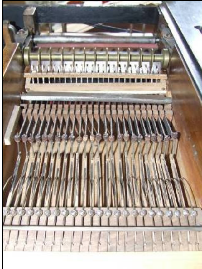
A szelepvezérlő mechanizmus a himbákkal. A háttérben a túskek és a szorítóhengerek láthatók.
